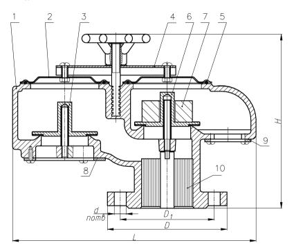
1- корпус клапана, 2 – крышка тарелки давления, 3,6 – тарелки вакуума и давления, 4 – прижимное устройство,5 – кольцо уплотнительное,7 – груз,8, 9 – защитные сетки, 10 –огнепреградитель.
